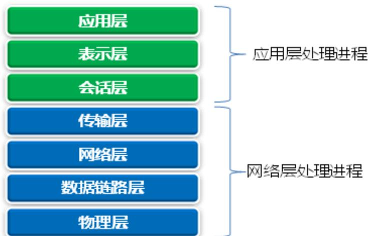
IPS-7000 系列的 DP 主要处理转发相关的工作，通过对数据包一次解析，按层次由对应模块处理，可以节省不同模块间重启解析数据包所消耗的资源，从而降低网络延迟。
