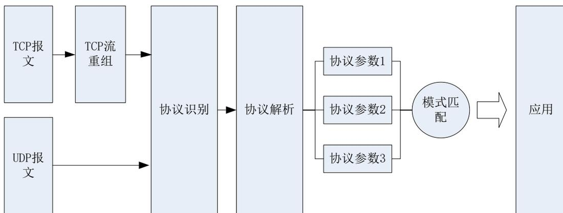
行为检测，不同的应用类型体现在会话连接或数据流上的状态各有不同；基于这一系列流量的行为特征，通过分析会话连接流的包长、连接速率、发送/接收的流量比例、包与包之间的间隔等信息来识别应用类型。
