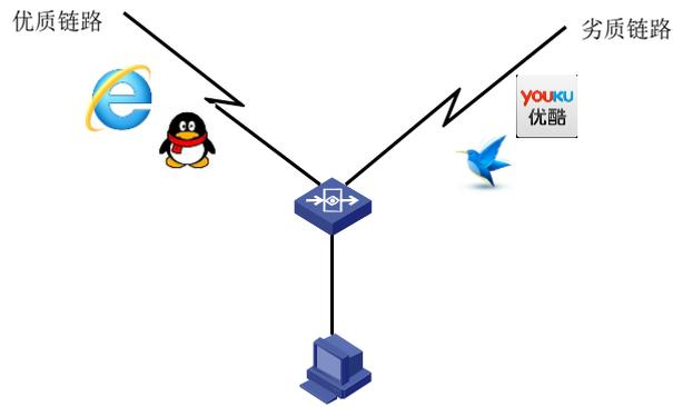
IPS-7000 系列的应用路由功能是不是基于端口，而基于应用来实现的，当发现某种应用的流量的时候，会把对应的 IP + 端口信息缓存在系统中，相同的 IP + 端口再次新建会话的会话，会命中相应的缓存，从而实现应用路由的功能。
