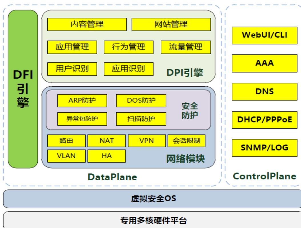
数据面: 传统的网关设备为了降低设计和开发难度, 会将各个模块以进程的方式存在, 数据包每通过一个模块都要重复对数据的解析。增加了数据包在系统停留的时间, 从而造成了网络延迟大的问题。
