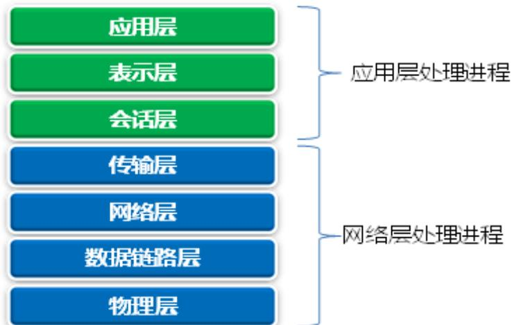
AG-6000 系列的 DP 主要处理转发相关的工作，通过对数据包一次解析，按层次由对应模块处理，可以节省不同模块间重复解析数据包所消耗的资源，从而降低网络延迟。
