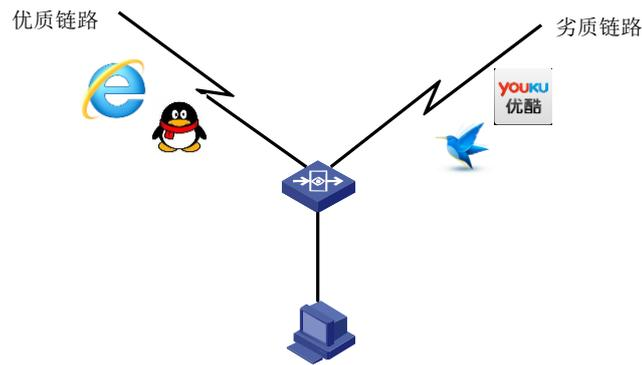
AG- 6000 系列的应用路由功能是不是基于端口，而基于应用来实现的，当发现某种应用的流量的时候，会把对应的 IP + 端口信息缓存在系统中，相同的 IP + 端口再次新建会话的会话，会命中相应的缓存，从而实现应用路由的功能。
